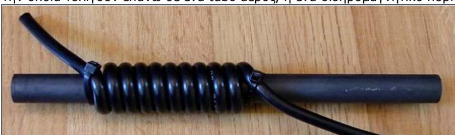
10 σπείρες RG-58 επάνω σε μια ράβδο φερριτική από παλιό ραδιόφωνο είναι αρκετές για την κατασκευή του απομονωτή.
