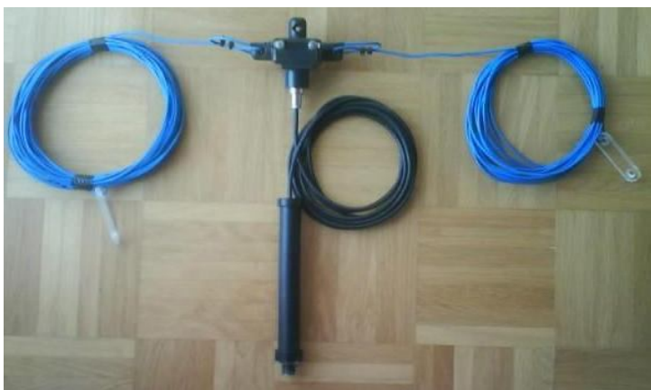
Έτοιμη κεραία Windom, εξοπλισμένη με balun 4:1, και isolator 1:1.
