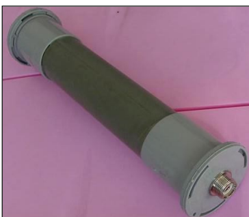
Ο απομονωτής έτοιμος για τοποθέτηση.
